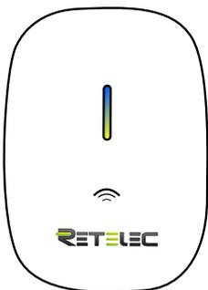
Si el indicador LED está fijo en color cian y la parte inferior parpadea en color amarillo indica que no hay suficiente corriente para cargar el vehículo.
