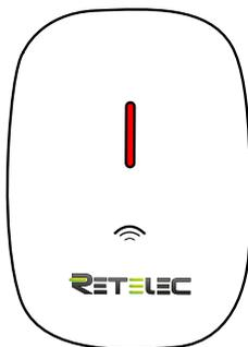
Si el indicador LED parpadea en color rojo está indicando que se ha producido un fallo de comunicación interna del cargador.
