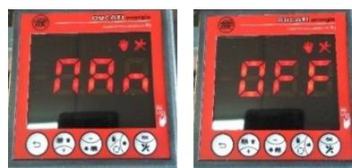
**14. COSENO DE PHI DESEADO. POR DEFECTO 0.98, NOSOTROS SIEMPRE BUSCAREMOS UN COSENO DE PHI 1 CAPACITIVO. SABEMOS QUE ES CAPACITIVO CUANDO NOS APARECE EL SIMBOLO DE UN CONDENSADOR A LA IZQUIERDA.**
