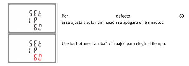
Pulse el botón "intro" para confirmar el ajuste y pulse el botón "esc" para volver al menú principal de configuración.
