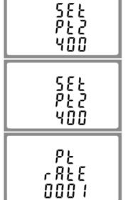
Use los botones "arriba" y "abajo" para seleccionar la opción de TT. La pantalla mostrara la tensión del secundario del transformador de tensión. El valor por defecto es 400V.
